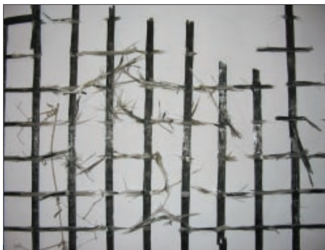
Fot. 3. B. I to ma być materiał zbrojący nawierzchnie bitumiczne? Przeplatane w węzłach z sobą poszczególne pasma tej siatki można bez wysiłku, ręcznie, w sposób dowolny, przemieszczać względem siebie. Widoczne starcia (wybielenia) powłoki bitumicznej, którą pokryta została siatka przez producenta – jeszcze przez kontaktem z nowonakładaną warstwą MMA.
