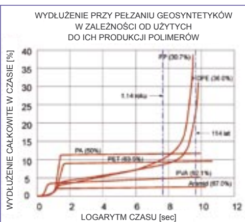
Rys. 1. Wydłużenie przy pełzaniu np. geosyntetyków, w zależności od użytych do ich produkcji polimerów. [2]
