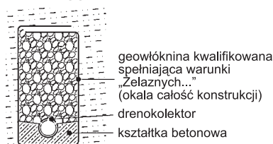
Rys. 2. Sposób umieszczenia drenokolektora w D.F.
