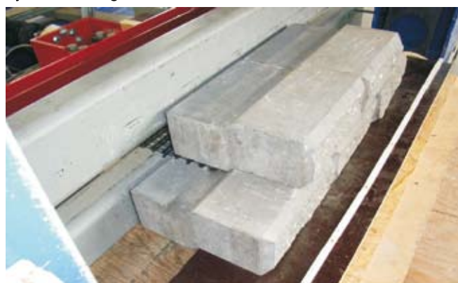
Fot. 2. Test na wyciąganie geosiatek Fortrac®, tBU, Greven, Niemcy
