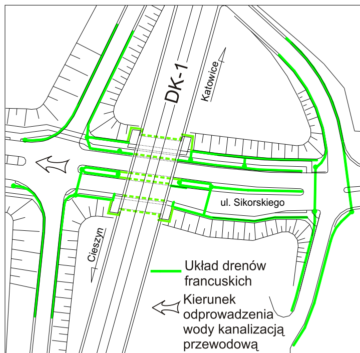
Rys.1. Schemat rozplanowania drenaży francuskich
